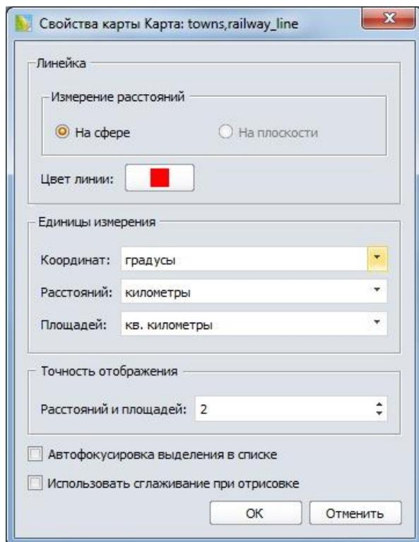
В разделе **Линейка** вы можете задать режимы использования инструмента **Линейка**: способ изменения и цвет линейки. См. подробности в разделах «Инструмент Линейка» на стр. 63 и «Режимы показа карт» на стр. 296.
